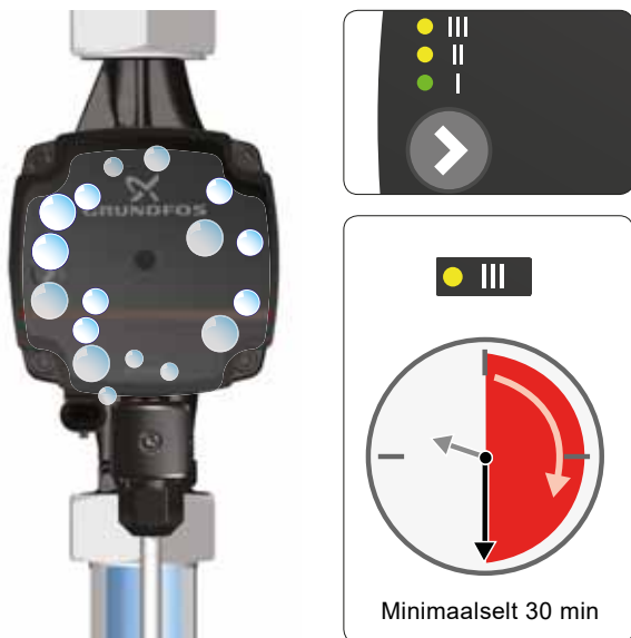
Joonis 7 Pumba läbituulutamine
