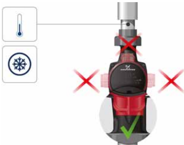
Joonis 4 Juhtploki asendid, õhu konditsioneerimise ja külmaveesüsteemid
